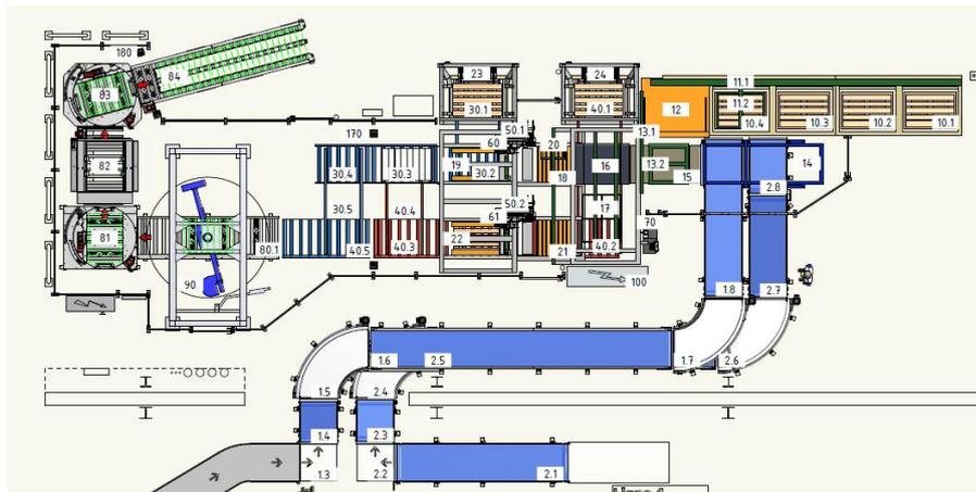
La machine LER1 est composée de trois zones. La première est l'arrivée des produits finis par deux convoyeurs selon la ligne de distribution. La seconde consiste à mettre le rouleau dans le carton et déposer les cartons sur une palette. La troisième permet l'emballage des palettes avec un plastique ainsi que leurs superpositions pour finalement les distribuer.
