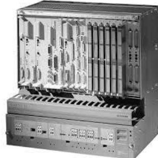
La machine fonctionne actuellement sous automate Siemens Step 5 et l'entreprise demande d'effectuer un retrofit pour implanter une intelligence moderne du même fabricant.
