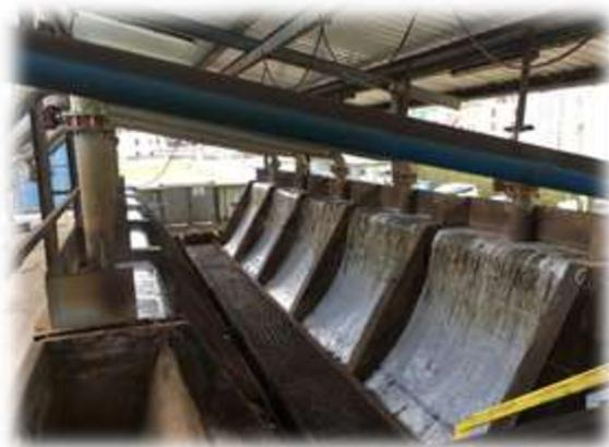
Un circuit de lavage fermé permet d'alimenter les jets des rideaux d'eau. L'eau chargée est ensuite filtrée sur des filtres statiques puis remise en pression pour alimenter les buses.
