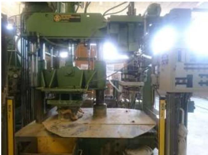
La machine est à la base commandée par un automate Siemens S5 datant des années 80. L'entreprise souhaite donc un retrofit électrique de la machine. Le but est de remplacer l'automate par un S7 1200 Siemens, de revoir le schéma électrique et le câblage et d'ajouter un panel opérateur.
